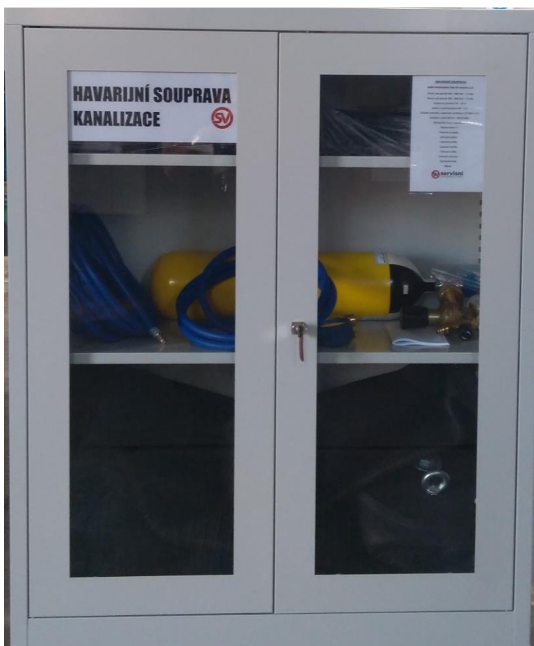
Obr.2: Havarijní souprava v plechové skříni
